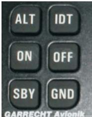
Die Auswahl der Betriebsart (Mode) erfolgt durch Drücken der Tasten **SBY**, **GND**, **ON**, **ALT**.
