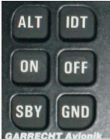
Das Einschalten erfolgt wahlweise durch Drücken der Tasten **SBY**, **GND**, **ON**, **ALT**. Das Gerät startet im gewählten Betriebsmodus.
